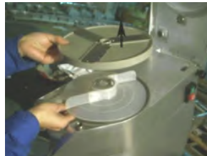
Instalación de lámina para cortar (4)
