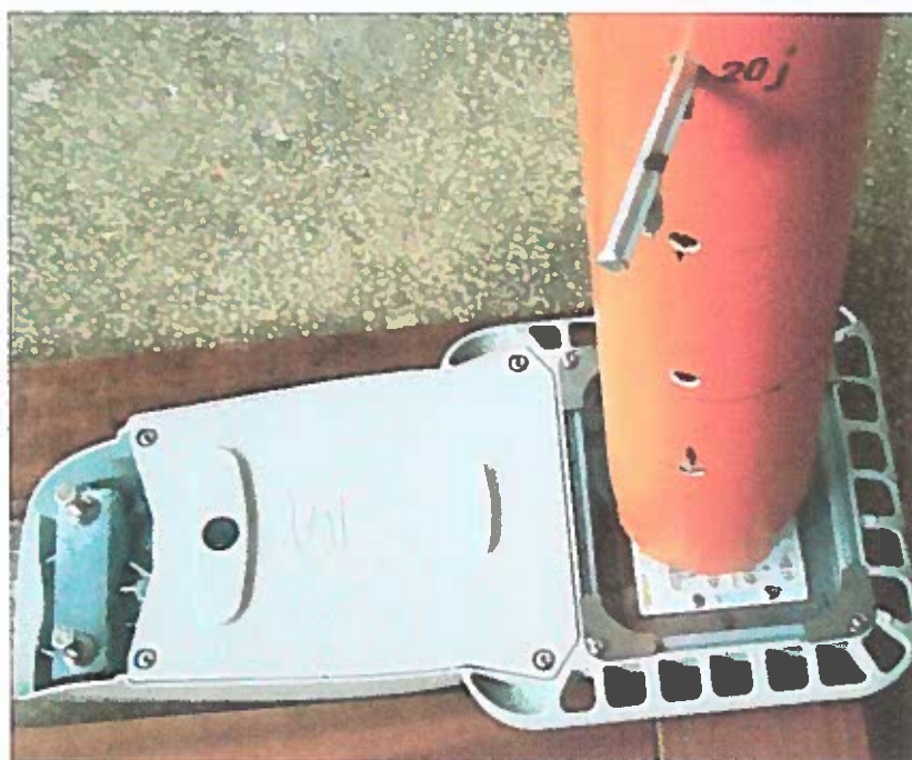
Fig. 2 – Corpul de iluminat VOLTANA2 16L – Cod VOLTA2-000037 pregătit pentru verificarea la impact (IK 10)
