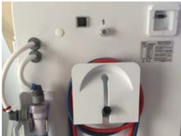
Imaginea 4-1 Depozitarea cablurilor și a tuburilor
