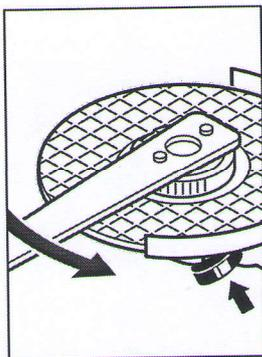
Dacă piulița de strângere rapidă este nedeteriorată și a fost fixată corespunzător, o poți detensiona manual, prin rotirea manuală în sens antiorar a inelului zimțat. **Nu slăbi niciodată cu cleștele o piuliță de strângere rapidă blocată, ci folosește cheia combinată în acest scop.** Așază cheia combinată conform imaginii.
