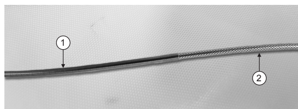
Afbeelding 3. Zilveren terugtrekbare buitenste sheath en gouden isolatiesheath
