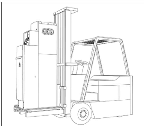
Рис. 2.1 Подъем ячейки cgmcosmos вилочным погрузчиком
