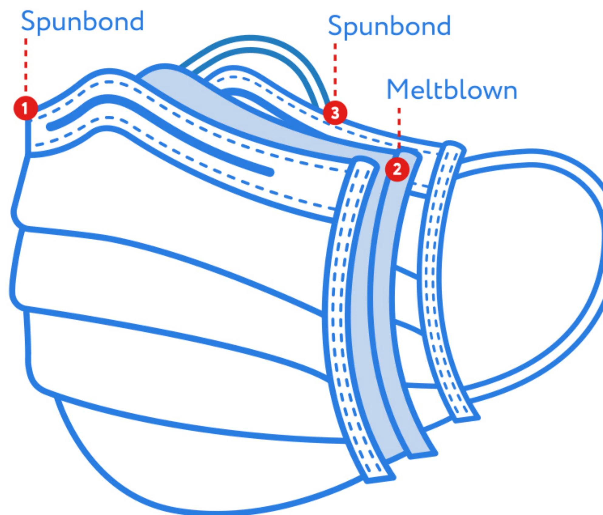
Două straturi laterale de Spunbond, cu funcția de filtrare și protecție a măștii; Meltblown, stratul de mijloc, oferă un coeficient de 99% de filtrare contra virușilor și microbilor.
