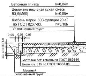
Конструкция покрытия тротуара бетонной плиткой
