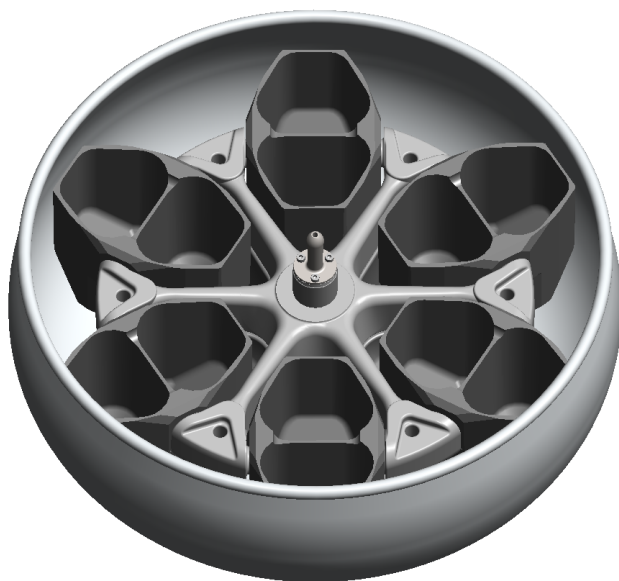
Figură III-8: Montați cupele în rotor, de ex. HAEMAFlex 12
