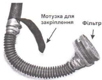
Кінець шлангу з фільтром
