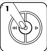
Включите измельчитель с помощью кнопки ВКЛ. (I), чтобы активировать функцию SafeSense®
