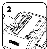
Прикоснитесь к контрольной поверхности и проследите, чтобы загорелся индикатор функции SafeSense®
