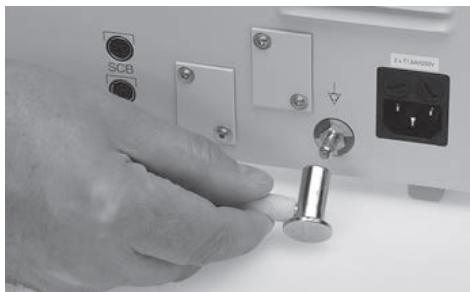
Das Gerät ist mit einer Steckvorrichtung ⑩ für den Potentialausgleich ausgerüstet.
