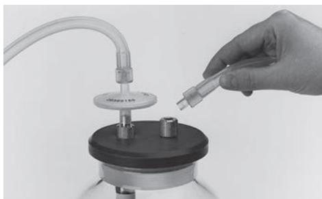
Sauganschluss ⑯ der Saugflasche über den Silikon-Saugschlauch mit dem Sauganschluss des Instrumentes verbinden.
