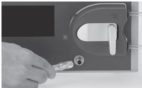
Das andere Ende des Saugschlauches mit Geräteanschluss ⑧ verbinden.
