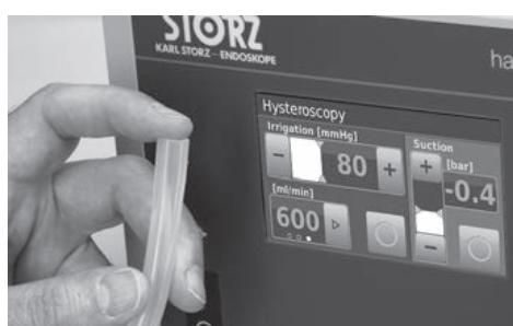
Den Start/Stopp-Button Saugen ⑯ betätigen. Absaugschlauch (Instrumentenschlauch) mit dem Finger verschließen und prüfen, ob sich ein Vakuum ausbildet. Der an der Balkenanzeige Istwert-Anzeige ⑯ abzulesende Saugdruck muss mit der Sollwert-Vorgabe (siehe »Dreiecke«) übereinstimmen.
