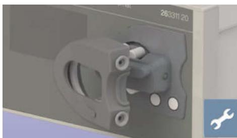
Mittels einer Animation wird das Aufsetzen der Schlauchkassette erklärt. Wenn alle Bedingungen erfüllt sind, d. h. eine gültig kodierte Schlauchkassette (HYS oder LAP) aufgesetzt ist und der Pumpenhebel geschlossen wurde, erfolgt der Sprung in die entsprechende Arbeitsebene (Hysteroskopie oder Laparoskopie).
