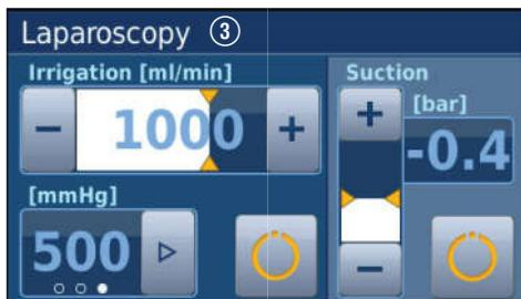
Der mittels der Schlauchkassette vorgewählte Anwendungsbereich (in diesem Fall »Laparoskopie« (3)) wird im Touch-Display angezeigt.
