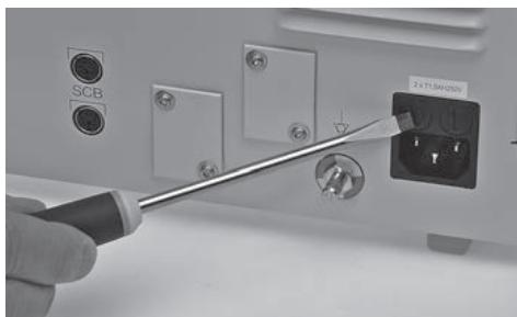
Sicherungshalter ② mit einem Schraubendreher oder anderem geeigneten Werkzeug lösen.
