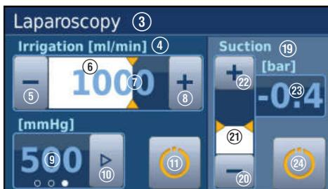
Bei aktiverter Saugpumpe (mittels Start/Stopp-Button ②₄) wird der Ist-Wert des Unterdrucks mittels eines weißen Balkens ②₁ angezeigt. Der aktuelle Sollwert wird über zwei orangefarbene Dreiecke in der Balkenanzeige dargestellt. Die Balkenanzeige spiegelt den gesamten Einstellbereich (Laparoskopie/Hysteroskopie: -0,1...-0,8 bar) wider.
