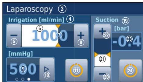
Den Start/Stopp-Button ⑪ drücken und die Spülspülung solange laufen lassen bis das Schlauchsystem komplett entlüftet (d.h. blasenfrei) ist.
