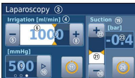
Über die ± Buttons ②₀ und ②₂ wird der Sollwert in 0,1 bar-Schritten verändert. Dies ist unabhängig vom Pumpenstatus.
