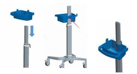
第二步:将胶篮按箭头方向套入立柱,并在胶篮前后各锁一颗M4×12螺钉固定
