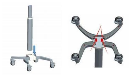
第一步:将立柱按箭头方向装配至底座,并在底座锁4颗M6×25内六角螺钉固定立柱。
