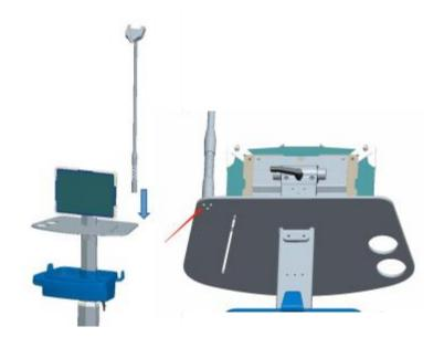
第五步:将支线架按箭头方向装至台面, 并在台面背部锁三颗M4×12螺钉固定。
