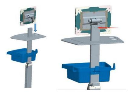
第四步:将平板支架按箭头方向装至立柱顶面,并在背面锁三颗M5×16内六角螺钉
