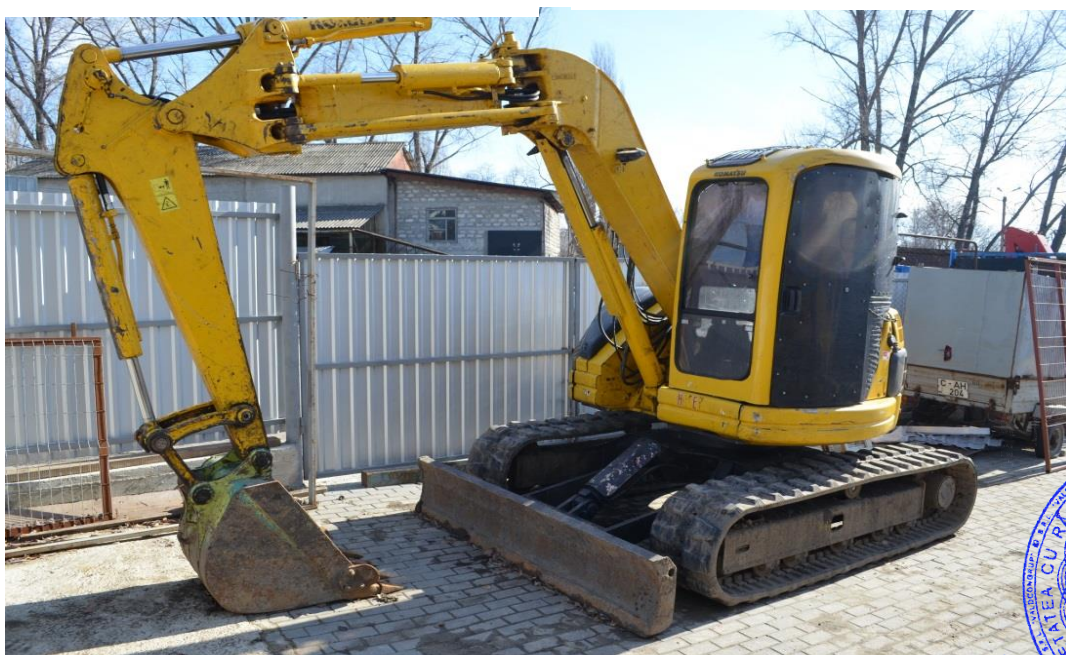
Figura 16. Vedere Nr.2 KOMATSU PC75UU-2
