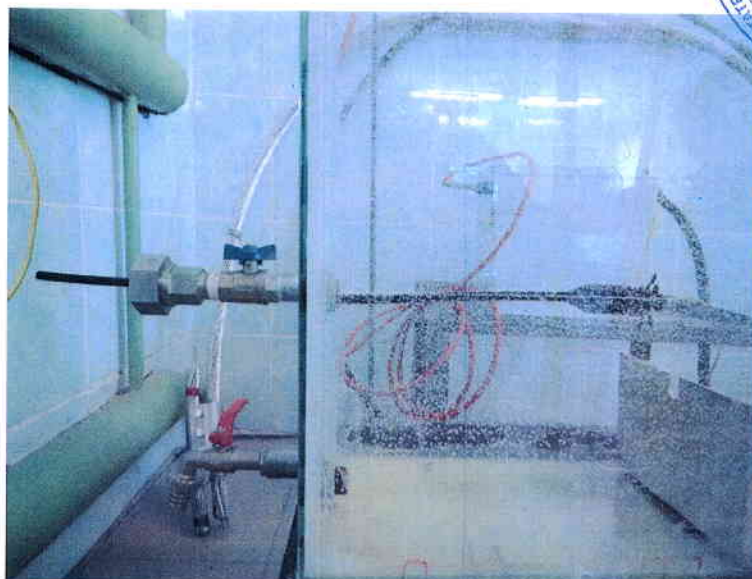
Рисунок В.1 – Схема проверки на герметичность адаптера AIZZ-40. Образец № 275-14.
