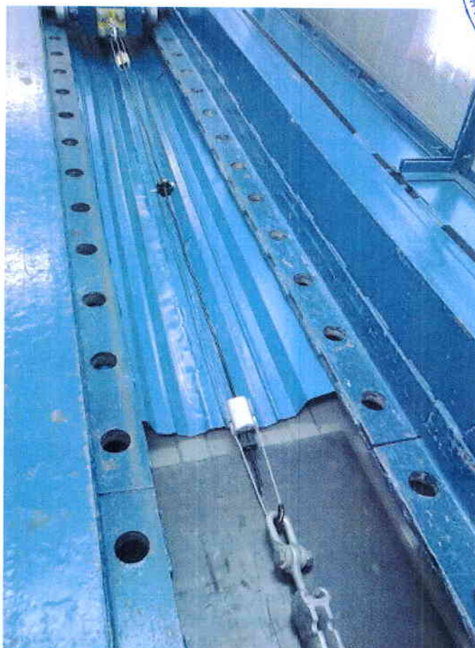
Рисунок А.3 – Схема проверки остаточной прочности магистрального провода СИП-4-1х16 (16 мм 2 ) (провод ответвления АПВ-4 (4 мм 2 )) с ответвительным зажимом ОР-645 на машине испытательной МИ-3-200. Образец № 412-14.
