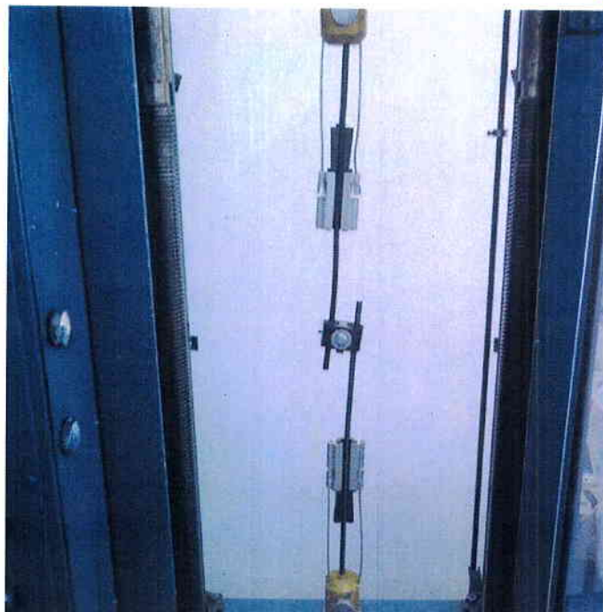
Рисунок Б.1 – Схема проверки прочности заделки провода ответвления СИП-4-1x16 (16 мм 2 ) (магистральный провод СИП-4-1x16 (16 мм 2 )) с зажимом ОП-95.1 на машине разрывной Р-5. Образец № 090-20.
