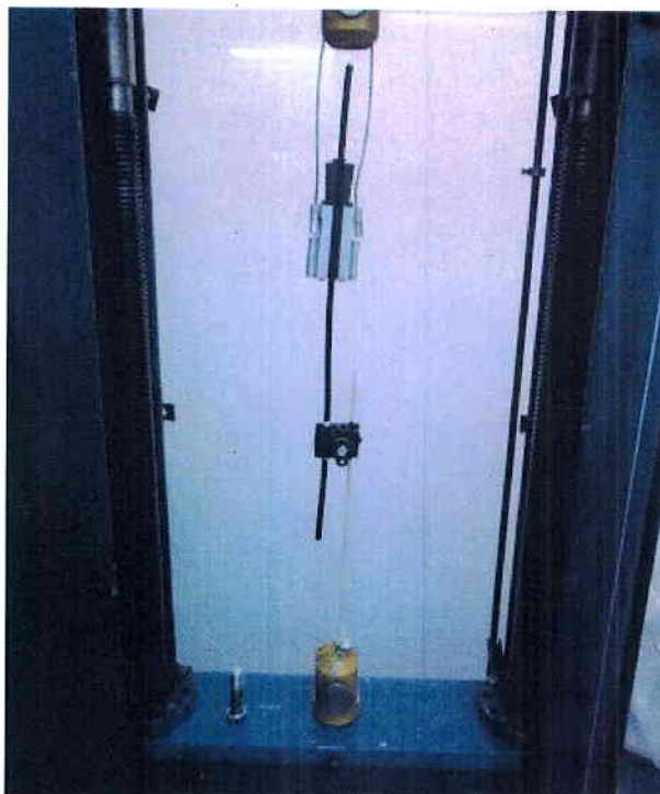
Рисунок Б.3 – Схема проверки прочности заделки провода ответвления АПВ-4 ( 4 \text{ мм}^2 ) (магистральный провод СИП-4-1x16 ( 16 \text{ мм}^2 )) в ответвительном зажиме ОР-645 на машине разрывной Р-5. Образец № 412-22.
