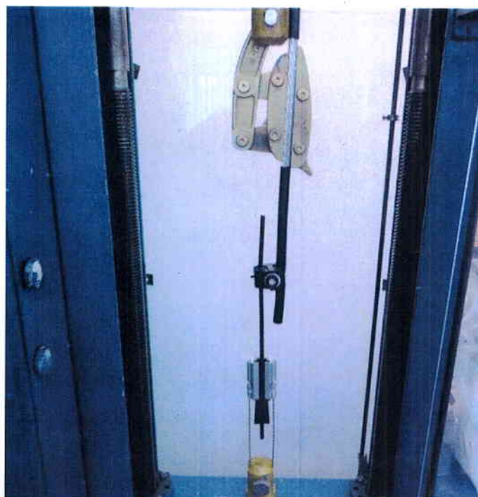
Рисунок Б.2 – Схема проверки прочности заделки провода ответвления СИП-4-1x16 (16 мм 2 ) (магистральный провод СИП-2-1x150 (150 мм 2 )) с зажимом ОП-95.1 на машине разрывной Р-5. Образец № 090-22.
