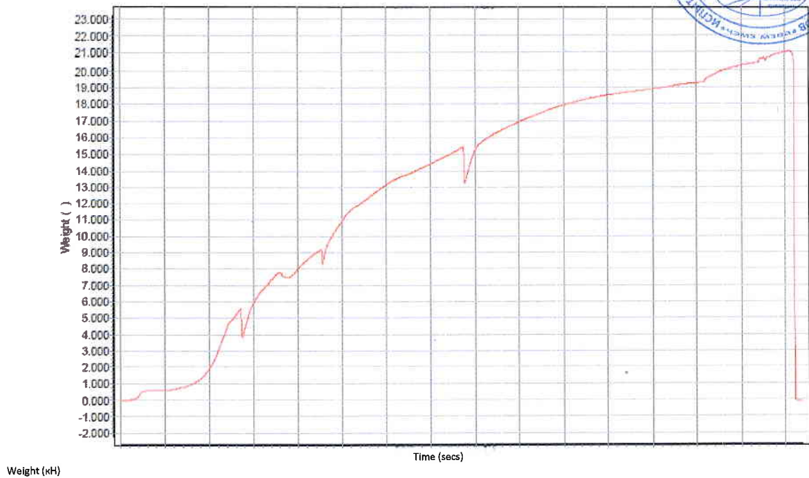
Рисунок А.3 – График приложения нагрузки при проверке разрушающей нагрузки анкерных зажимов РА-2200, Образцы № 565.2-11, № 565.2-12.
