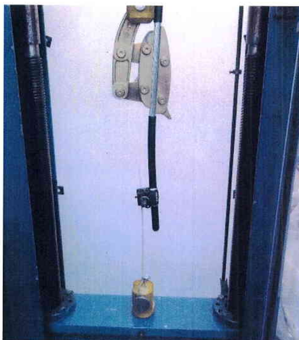
Рисунок Б.4 – Схема проверки прочности заделки провода ответвления АПВ-4 ( 4 \text{ мм}^2 ) (магистральный провод СИП-2-1x150 ( 150 \text{ мм}^2 )) в ответвительном зажиме ОР-645 на машине разрывной Р-5. Образец № 412-24.
