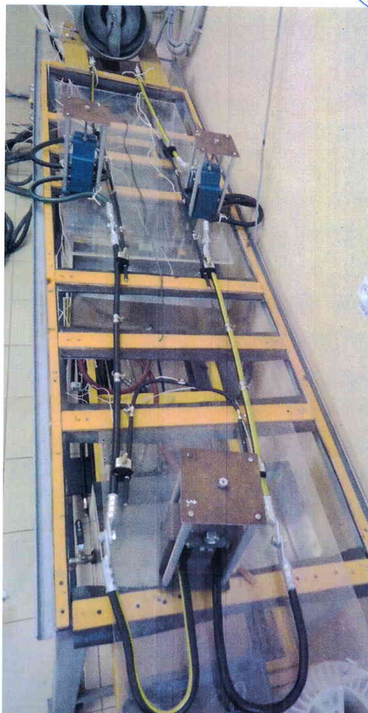
Рисунок Г.1 – Схема проверки на электрическое старение зажимов ОР-645.1м с магистральным проводом СИП-2-1х150 (150 мм 2 ) и проводом ответвления СИП-2-1х50 (50 мм 2 ) (сечения проводов: максимум-максимум). Образцы №№ 099-46...099-51.
