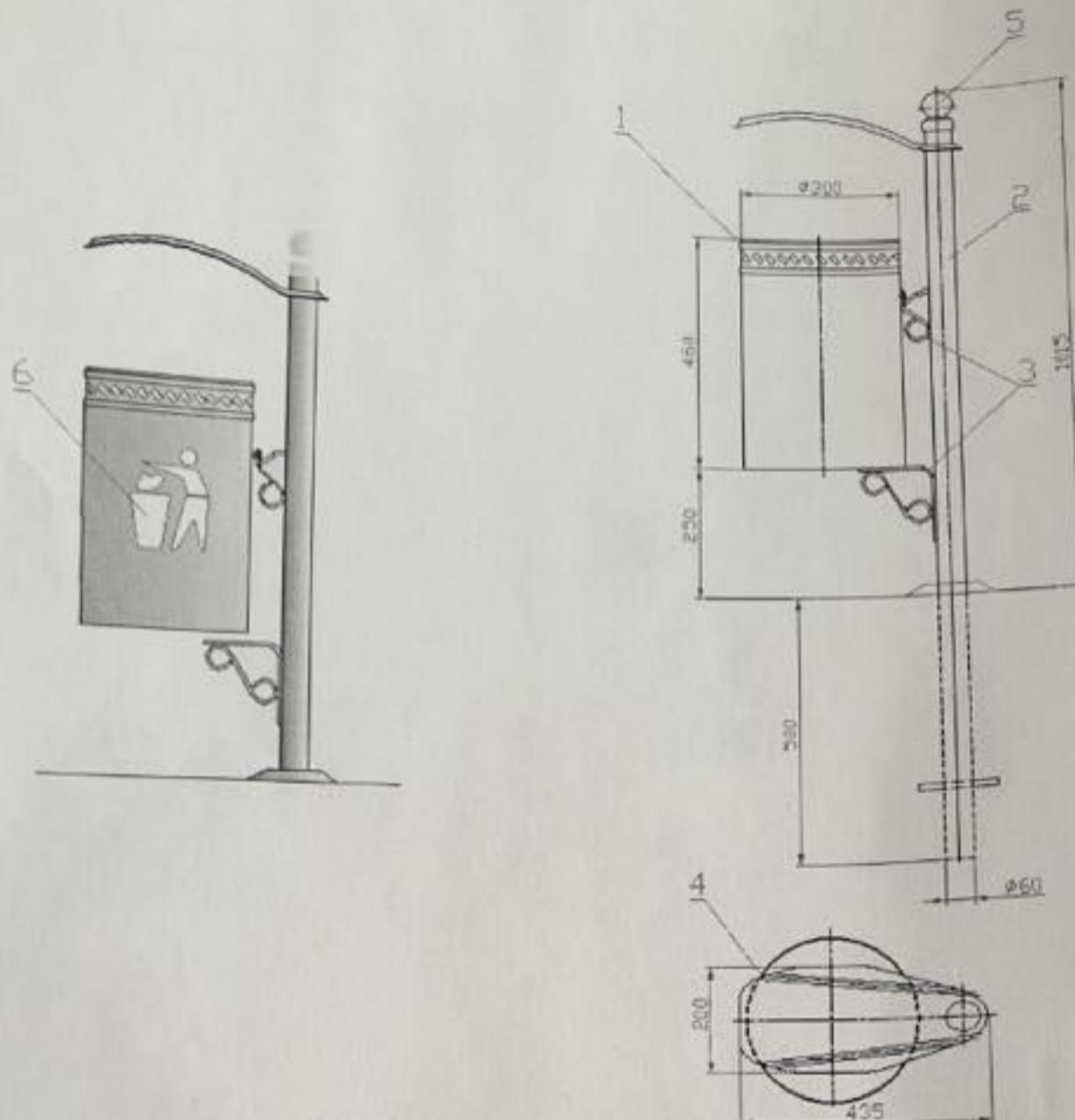
Поз.1. Корзина урны цилиндрической формы из листа толщиной не менее 1 мм, в верхней стороне выполнена крупная перфорация – указатель наполненности корзины и два зига для придания жесткости верхнему краю
