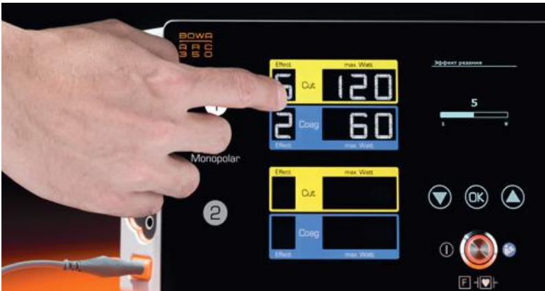
Просто: для настройки эффектов или значений мощности достаточно коснуться соответствующего поля, после чего активируется меню ввода данных в центре ARC 350
