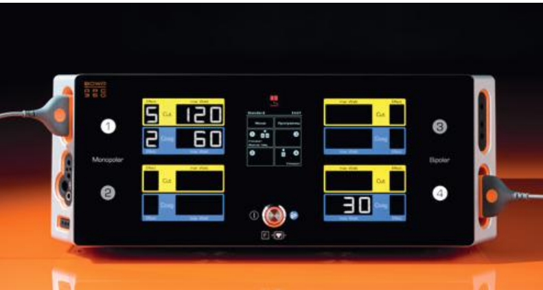
Наглядно: каждый подключенный разъем, на изображении это верхний левый и нижний правый разъемы, соотносен с определенным квадратом экрана
