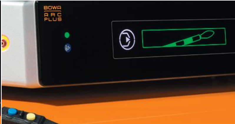
Зеленый цвет индикатора сигнализирует о предварительном промывании аргон
