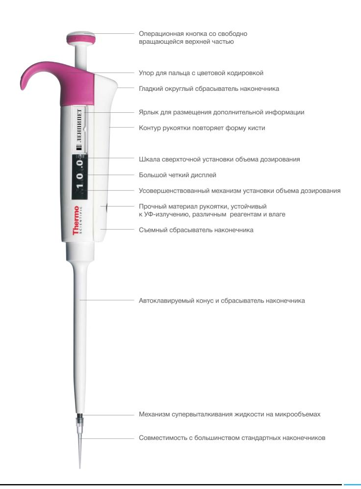
**6** Дозатор механический Ленпипет Лайт
