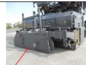
Seitenbleche hinter der Bohle abgeklappt Side plates closed behind the screed
