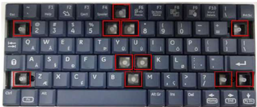
Figure 8-154 Remove key : '1', 'Left Shift', 'F5', '6', '7', 'H', 'J', 'N', 'Back space', 'Right Shift', 'Pg Up'
