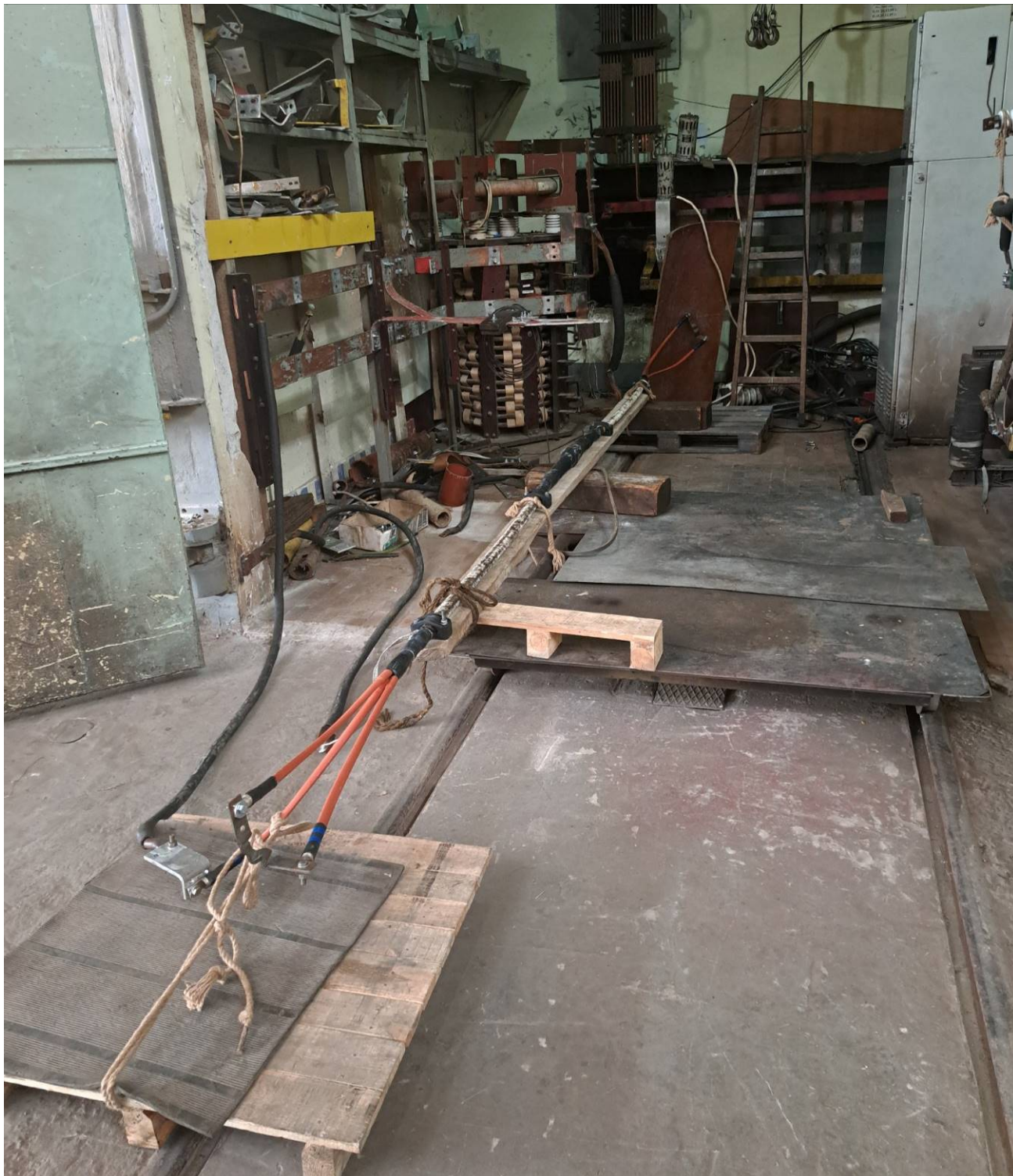
Рисунок 8.7 – Зовнішній вигляд зразка під час випробувань на термічну стійкість під час короткого замикання
