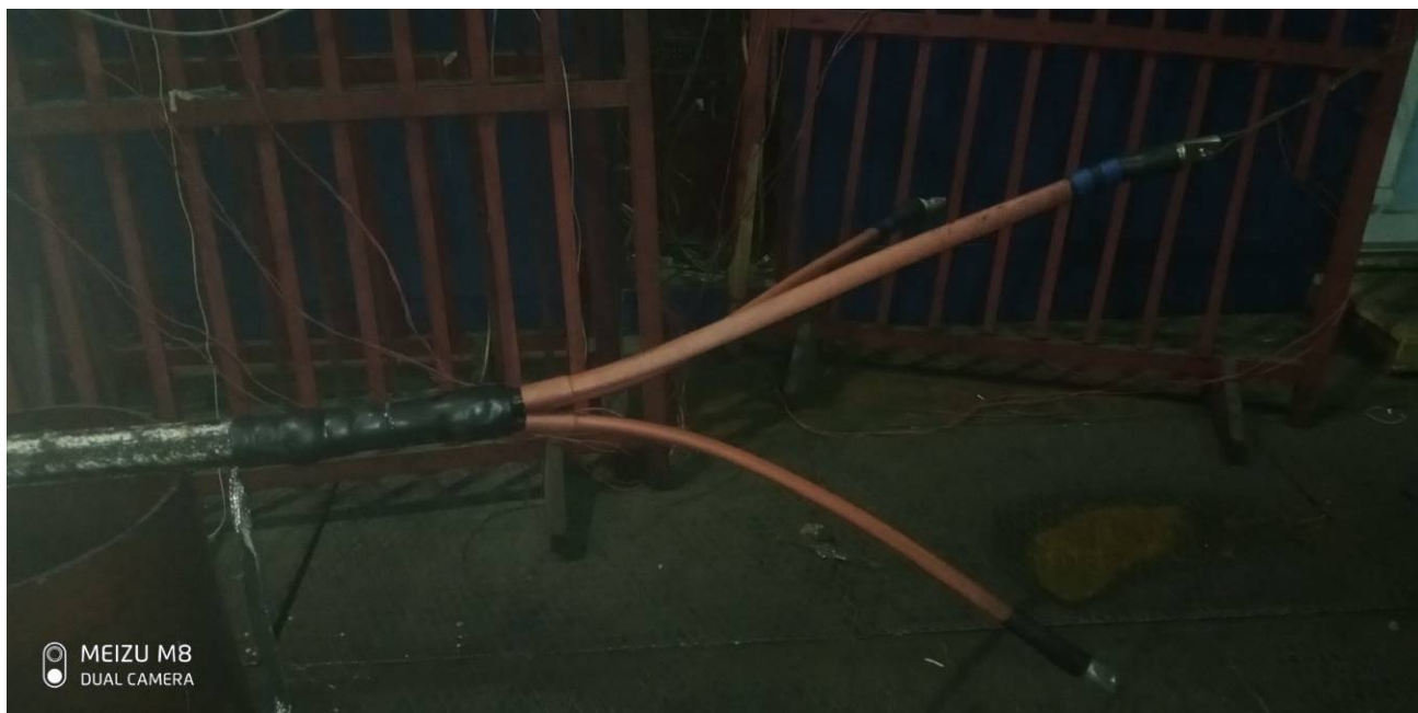
Рисунок 8.6 – Зовнішній вигляд зразка після випробувань в сольовому тумані
