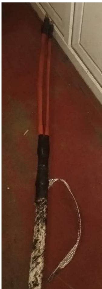
Рисунок 8.2 – Загальний вигляд термоусаджувальних кінцевих муфт типу 10KV(H)TP (зовнішнього та внутрішнього встановлення).
