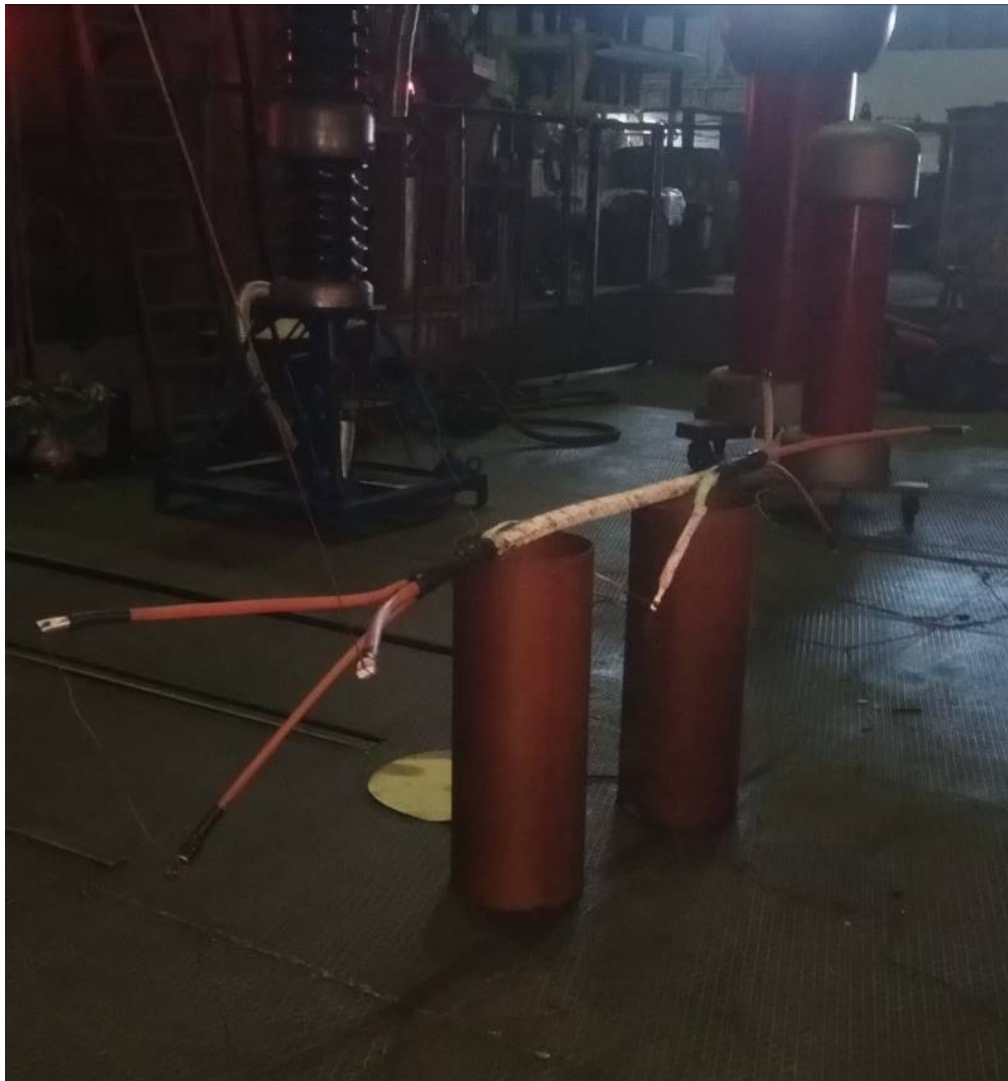
Рисунок 8.3 – Випробування напругою змінного струму 50 Гц в сухому стані та під дощем
