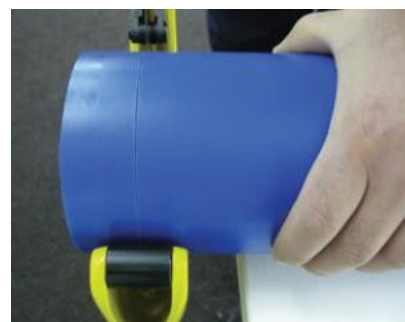
Cu mișcare circulară ușoară, tăiați stratul exterior din PP
