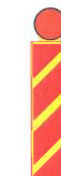
T7.9 Lumini "fulger" în cascadă pentru delimitarea zonei de lucru, de culoare roșie sau portocalie
