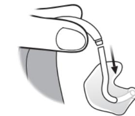
Отсоедините трубочку и вкладыш от звукового крючка. При этом крепко держите аппарат за крючок, а не за корпус. В противном случае Вы можете повредить слуховой аппарат.
