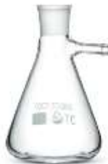
Исполнение 2 с взаимозаменяемым конусом
