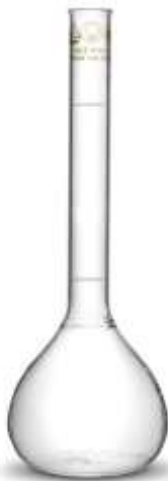
Исполнение 3 с двумя отметками
