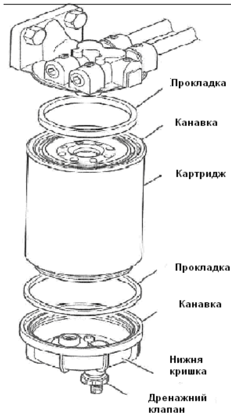
Рисунок 12.6.1.3 – Паливний фільтр грубого очищення в відсіку кузова
