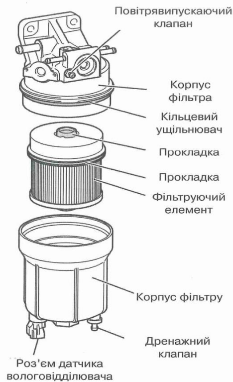
Рисунок 12.6.1.2 – Будова паливного фільтра на двигуні
