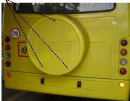
Гайки кріплення захисного кожуха
