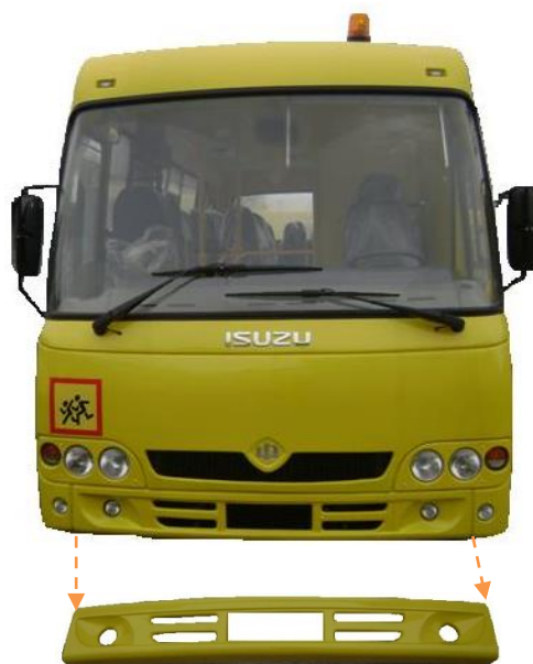
Рис. 16.2 Демонтаж середньої частини бампера
