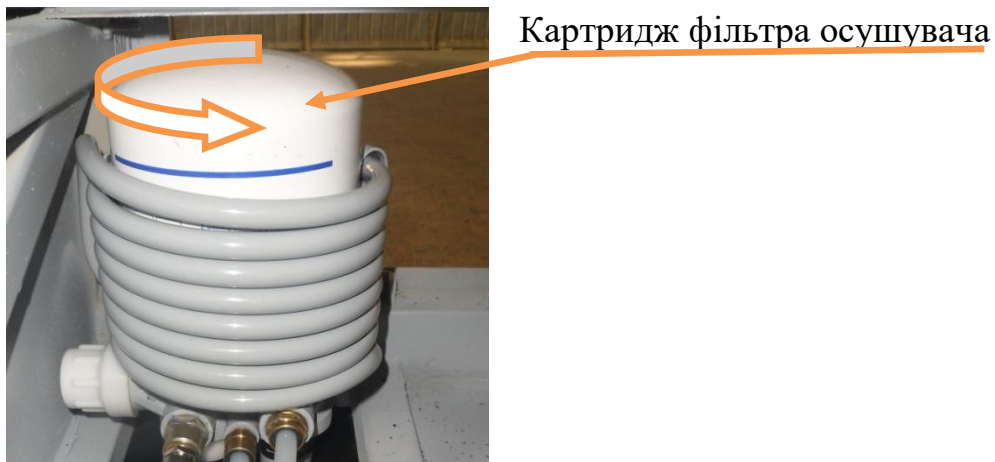
Рисунок 12.11.1.3 Викручування картриджа фільтра осушувача
