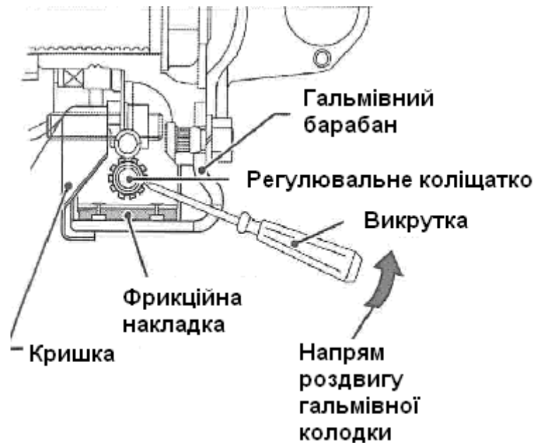
Рисунок 12.7.1.4.3 – Регулювання стоянкового гальма
