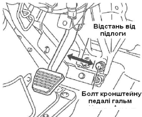
Рисунок 12.7.1.3.1 – Відстань між важелем педалі та кронштейном педалі (відстань до підлоги) під тиском 490 Н (50 кгс)
