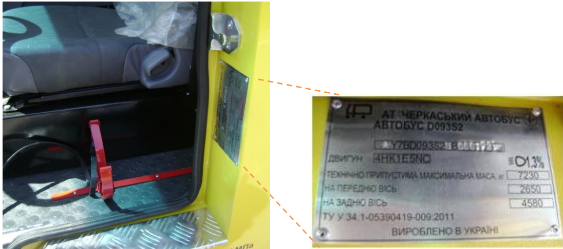
Рисунок 6 – Ідентифікаційний номер (VIN код) автобуса на табличці, яка встановлюється в правій нижній частині пройми дверей водія
