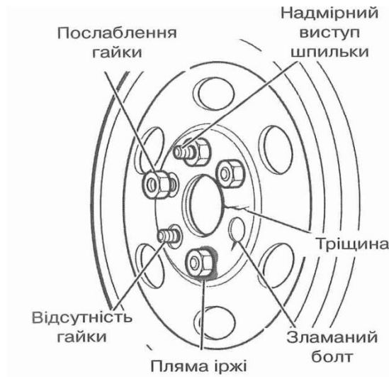
Рисунок 12.7.2 – Надійність встановлення коліс
