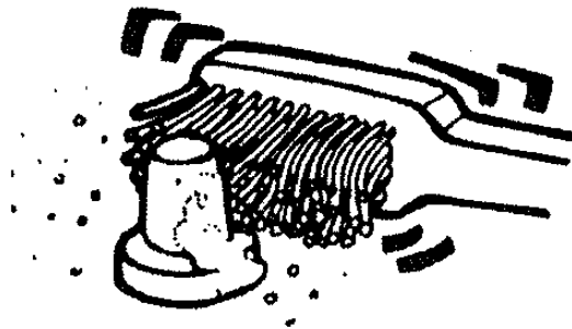
Рисунок 12.9.3.5 – Очищення клеми від корозії
