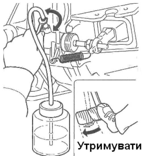
Рисунок 12.7.4.1.1 – Видалення повітря з системи зчеплення
