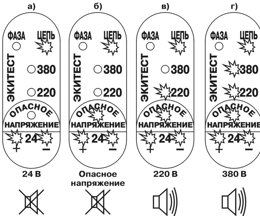
Рис.3 Индикация уровня постоянного напряжения
