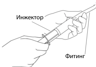
Рис. 5-4 Использование инжектора для очистки фитинга
