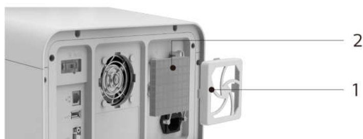
Рис. 7-4 Замена хлопкового фильтра вентилятора
