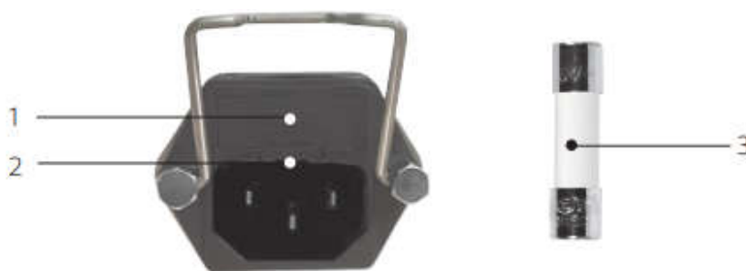
Рис. 7-1 Демонтаж предохранителя питания переменного тока
