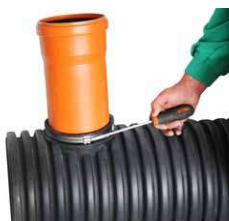
6. Se fixează colierul din plastic și se strânge la 6 Nm
