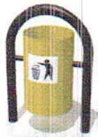
Constructia este constituita din carcasa din otel si cos pentru gunoi rotativ. Carcasa este realizata din teava de otel cu diametrul de 48mm. Elementele metalice sunt sablate și vopsite în camp electrostatic, în două straturi cu grosimea de 100 microni pentru a le conferi rezistență la mediul exterior. Materiale: otel, plastic. Dimensiuni: Lungime: 440mm, Lătime: 300mm, Înălțime: 660mm.
