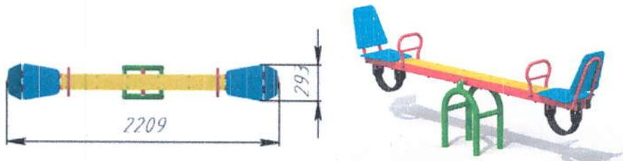
Componente: construcția este constituită din suportul de ieagnare cu cieminte de amortizare din cauciuc, scaune și manere, baza metalică.
