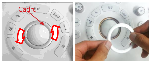
[Figura 4.1 Demontarea cursorului trackball]
