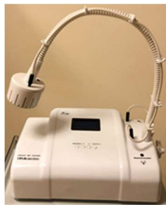
Рисунок 12 Установка индуктора на электрододержатель.
