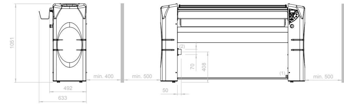
(1) ЭЛЕКТРИЧЕСКОЕ ПОДКЛЮЧЕНИЕ (PG13.5)
