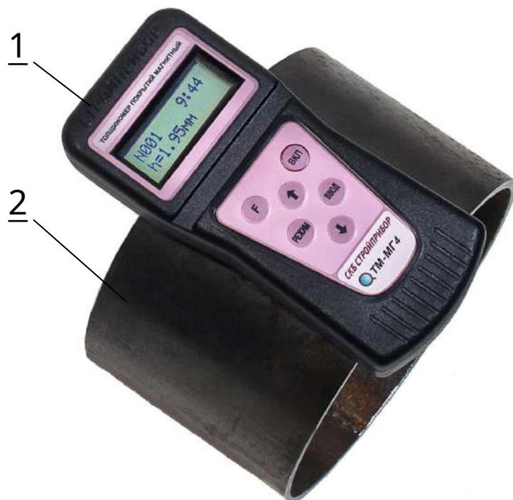
Figura 2.1 – Poziția indicatorului de grosime pe produs la măsurare
