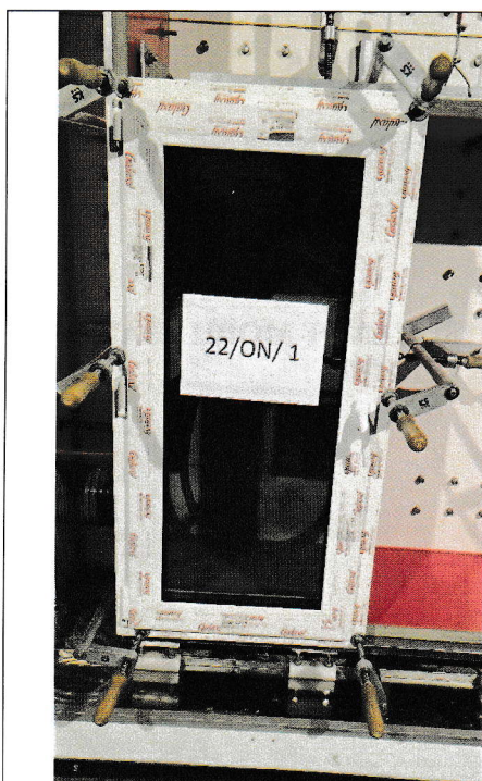
Fig.1 Aspect fereastră din profile PVC tip GALAXY 76MD cu 6 camere, cu un canat mobil, batant, cu deschidere dreapta spre interior
