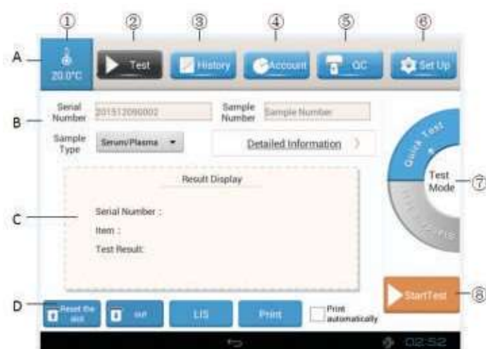
A: Funcții; B: Informații privind dispozitivul de testare; C: Afișarea rezultatelor; D: Pictograme
