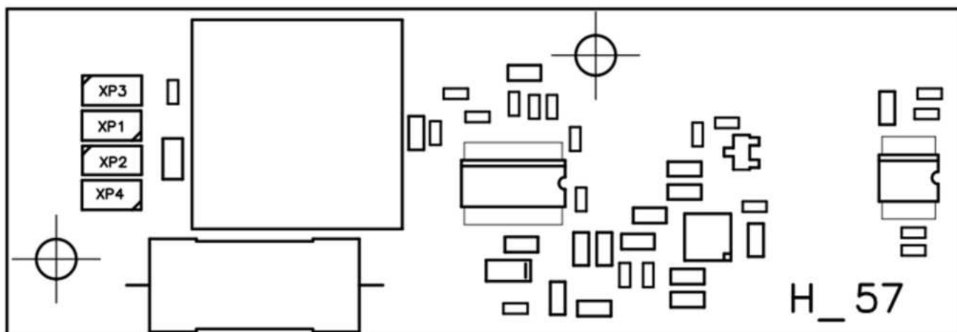
Рис. Б.3– Розташування перемичок на модулі Bell202
