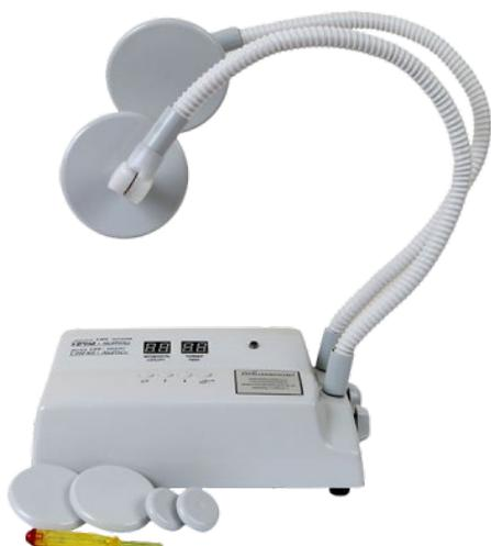
Аппарат УВЧ-терапии УВЧ-60 (МедТеКо) предназначен для местного лечебного воздействия электромагнитным полем высокой частоты. Номинальное сопротивление нагрузки – 50 Ом. Оптимальный зазор электродов – 15 мм. Время выхода аппарата на рабочий режим, не более – 1 мин. Время работы аппарата в повторно-кратковременном режиме – 6 ч. Время работы – 20 мин. Время паузы – 10 мин. Диапазон установки таймера – 0...99 мин  $\pm 5\%$ . Рабочая частота аппарата – 27,12 МГц  $\pm 0,163$ .
