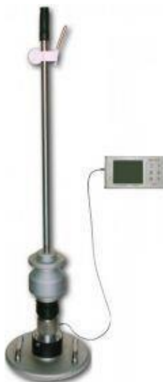
Figura. 1.11. Utilaj de măsurare a coeficientului de compactare ПДУ-МГ4.
