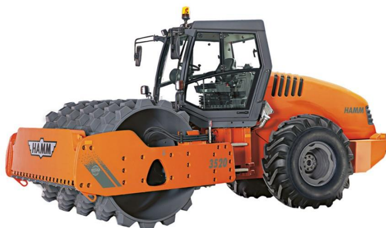
Figura. 1.12. Compactor de tip picior de oaie pentru compactarea terasamentului.
