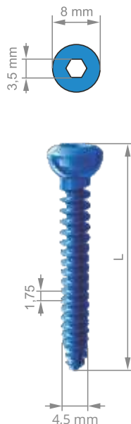
WKRĘT DO KOŚCI GĄBCZASTEJ samogwintujący CANCELLOUS SCREW self-tapping ø 4,5 x 1,75 mm
