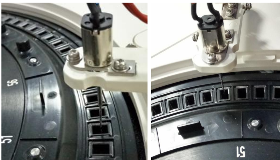
图 5-13 搅拌棒在反应杯正中间
