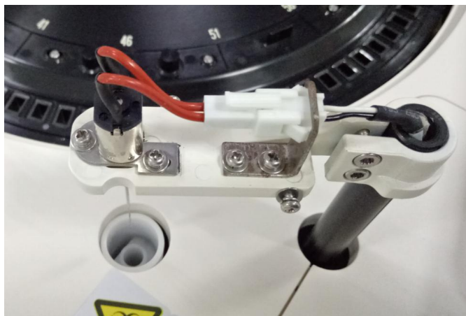
图 5-17 搅拌棒到清洗槽位置
