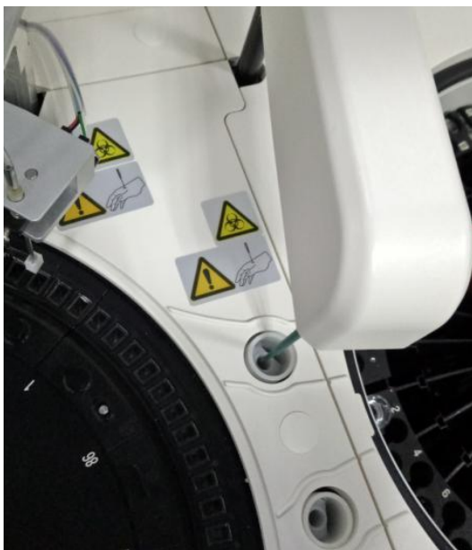
图 5-15 试剂针到清洗槽位置
