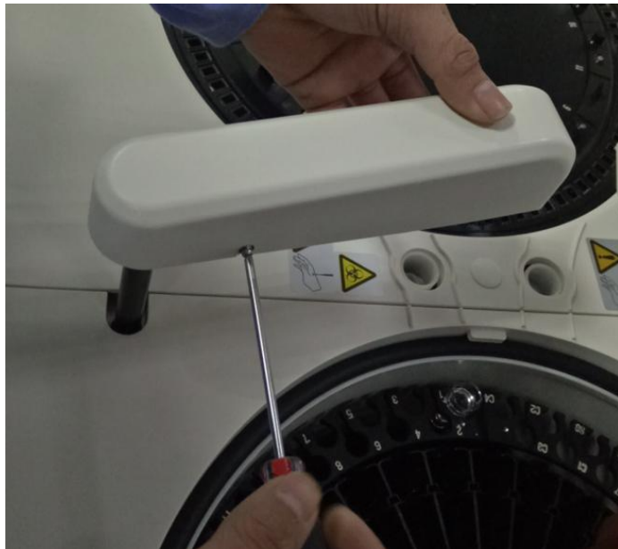
图 4-20 拧松样本臂罩螺钉
