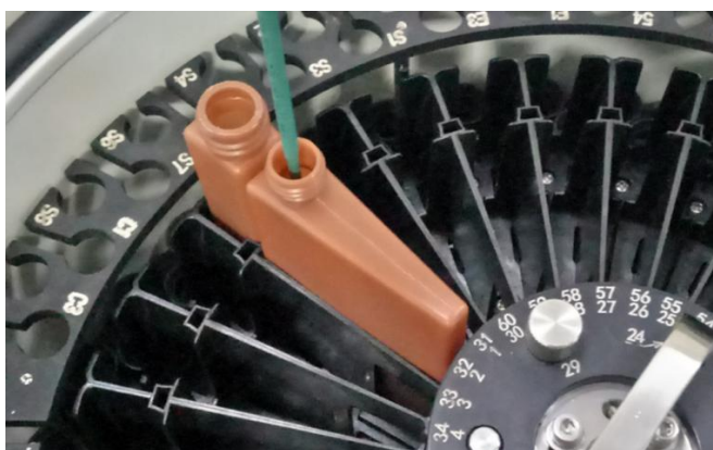
图 5-26 试剂针在 1 号试剂位正中间
