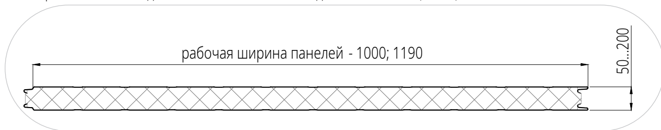
Рисунок 15. Геометрия стеновой сэндвич-панели с замковым соединением Z-Lock (ПСТ Z)
