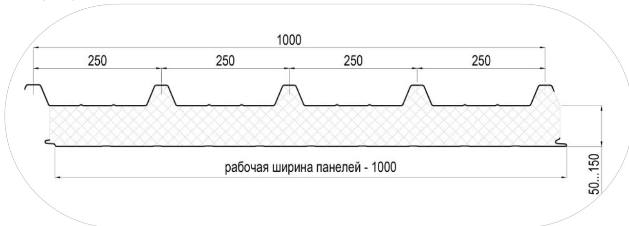
Рисунок 25. Геометрия кровельной сэндвич-панели с замковым соединением типа Z-Lock (ПКТ Z)
