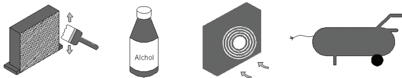
Figura 6 La limpieza del condensador
