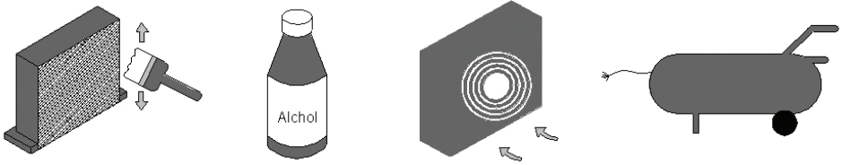
Bild 6 Reinigung des Kondensators
