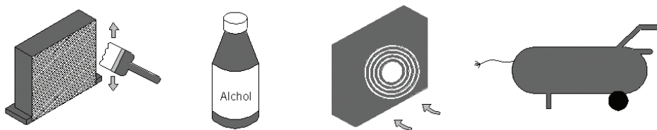
Figure 6 Nettoyage du condenseur
