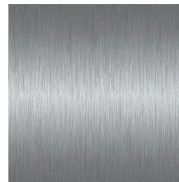
Placaje păreți cabina , ușile ascensorului, înrămarea ușilor - Material Oțel inoxidabil periat (SATIN)
