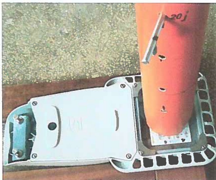
Fig. 2 – Corpul de iluminat VOLTANA2 16L – Cod VOLTA2-000037 pregătit pentru verificarea impact (IK 10)
