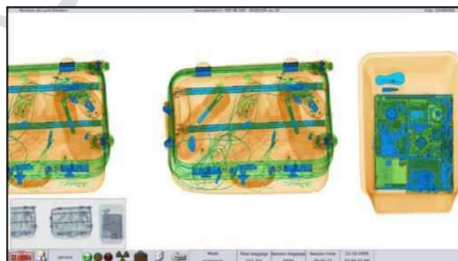
Figura 11 - Imagine tipică cu raze X pe 1 monitor afișate de către FEP ME 640: vizualizare color și alb-negru în miniatură
