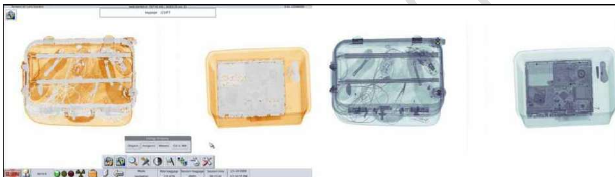
Figura 49 - Eliminarea energiei: eliminarea materialelor metalice și anorganic
