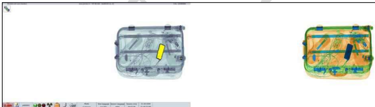
Figura 60 - Alarmă densitate bagaj
