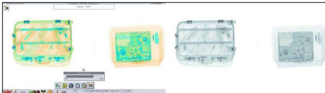
Figure 47 - Afișaj bazat în principal pe datele de înaltă energie: detaliile pentru cea mai înaltă absorbție sunt afișate, altfel ar fi invizibile
