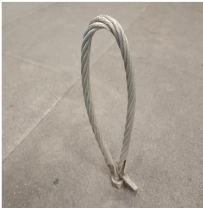
Рис.6 Петля для разгрузки БКРП.
