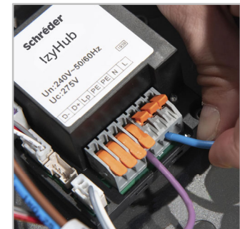
Modulul IzyHub, elimină posibilitatea apariției erorilor de conectare, ușurează conexiunea electrică la instalare și în timpul operațiunilor de mentenanță.
